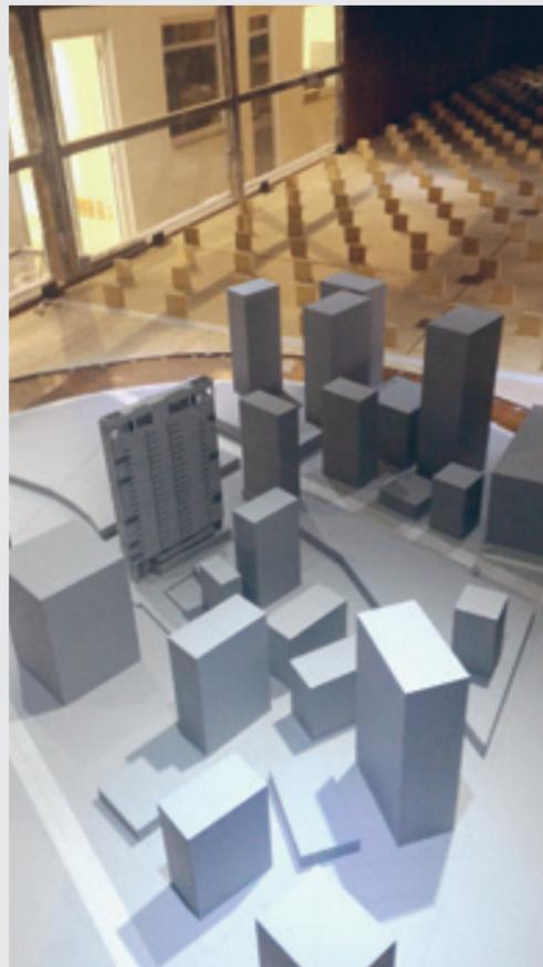
Ensaio no túnel de vento do IPT com a maquete do edifício
